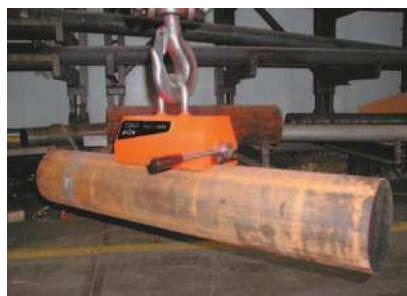
NEO 1000: Захват и перенос монолитного материала круглого сечения
