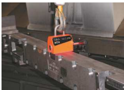
NEO 250: Загрузка/разгрузка отливки с обрабатывающего центра
