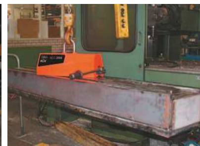
NEO 2000: Перемещение тяжелого элемента металлической конструкции
