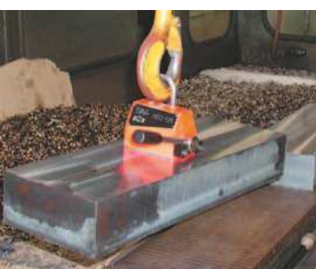
NEO 125: Загрузка/разгрузка фрезерного станка
